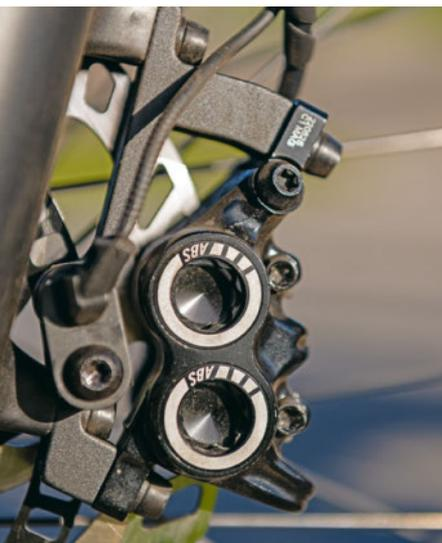
**Wirkungsvolle** Vierkolbenbremsen sind Voraussetzung für gute Bremsleistungen.
