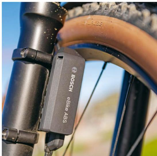
**Die Bosch-ABS-Kontrolleinheit** ist an der Gabel montiert und wiegt nur wenige 100 Gramm.
