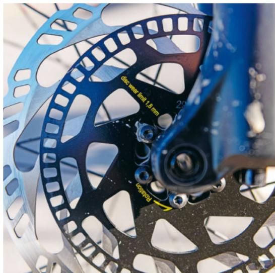
**Radgeschwindigkeits-Sensoren** überprüfen am Vorder- und Hinterrad die Geschwindigkeit.
